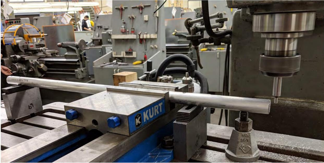
*Figure 3.27: Edge Finder Used on Fuselage*
