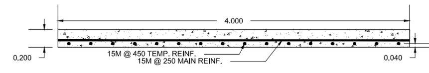
PUMP PAD PLAN - SECTION A1
